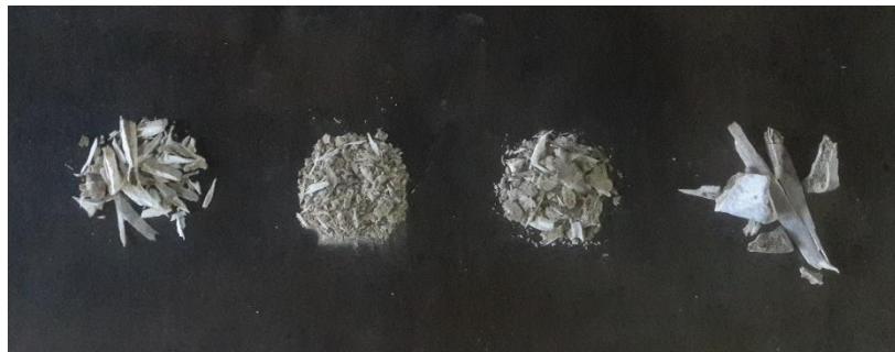
Şekil 1. Kullanılan farklı boyutlardaki kemik granüllerine ait fotoğraf.
